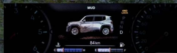
**MUD** permite derrapagem adicional da roda para aumentar a tração a baixas velocidades, através de controles especificamente regulados do chassi, dos diferenciais e das relações de transmissão de modo a enfrentar a lama com sucesso.
